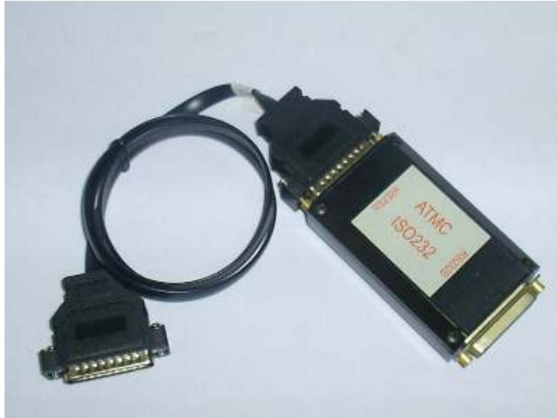
O **ISO232** é um equipamento destinado a realizar o isolamento óptico de interface serial RS-232, visando proteger os equipamentos a esta conectado, e, sujeitos a riscos de sobretensão tais como ambientes de alta potência de energia
